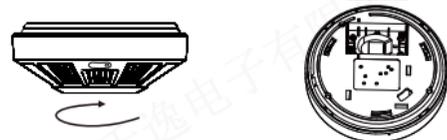
1、将报警器逆时针旋出挂机板
